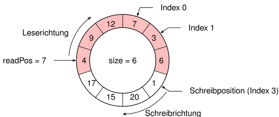
Der Ringpuffer enthält sechs Elemente (rote Felder, gelesen wird in der Reihenfolge 4, 9, 12, 7, 3, 6) und es können noch vier weitere Elemente gespeichert werden (dabei werden die weißen Felder 1, 20, 15 und 17 überschrieben).
